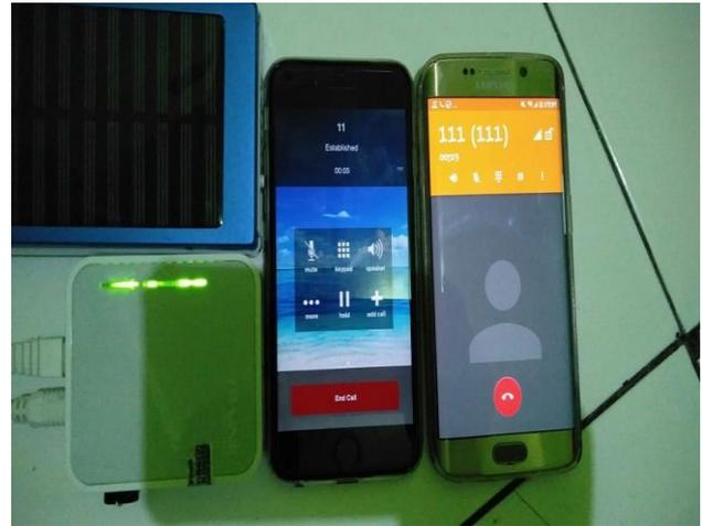
Gambar. 9. Prototype Voip Server pada saat melakukan panggilan
