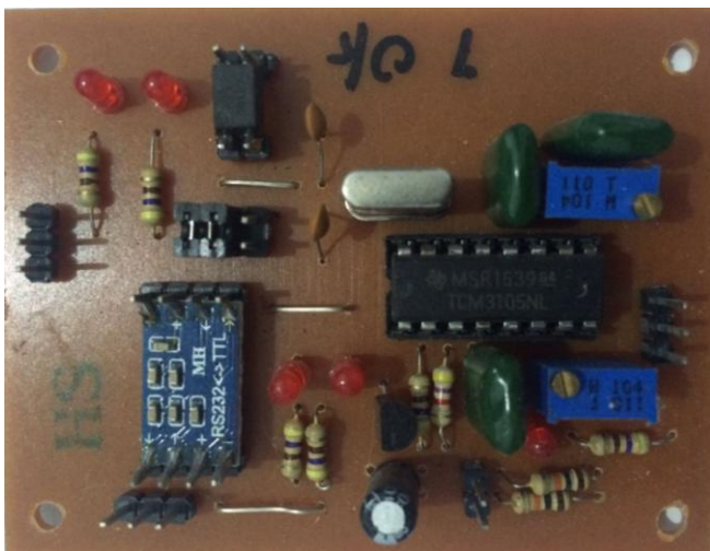
Gambar. 10. Modul modem FSK menggunakan IC TCM3105 yang selesai dibuat
