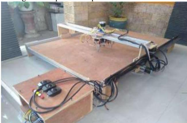
Gambar 3. Bentuk fisik tahap awal prototype Mesin Batik Tulis Digital Dilengkapi 3 Canting Batik
